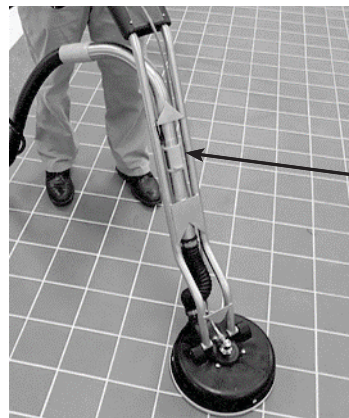
Cubierta del freno de aspiración
